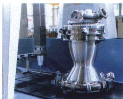
图4 完全装配的燃烧室中运用在DMG加工中心加工的部件
