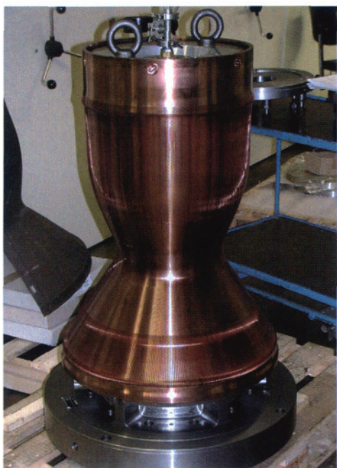
(a) 燃烧室内采用铣削加工的冷却管
